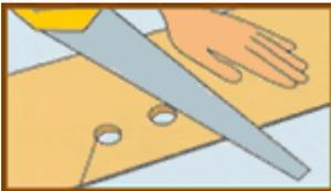
**10.** Если длинная сторона доски упирается в трубу, просверлите отверстие диаметром, превышающим диаметр трубы примерно на 16 мм, для создания компенсационного зазора вокруг трубы. Отметьте карандашом линию отреза. Отпилите кусок доски, который будет располагаться за трубой ближе к стене. Держите пилу под углом, как показано на рисунке. Если в трубу упирается короткая сторона доски, вставьте пилу в отверстие и пилите под углом 90°.
