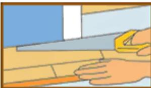
**12.** Дверные коробки можно снять и отставить в сторону, но их также можно подпилить. Используйте обрезок доски в качестве шаблона для отметки линии отреза. Подпилите дверную коробку мелкозубчатой пилой. Заведите доску под коробку. Проследите за тем, чтобы доска не оказалась зажатой между основанием и дверной коробкой.
