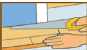
**11.** Дверные коробки можно снять и отставить в сторону, но их также можно подпилить. Используйте обрезок доски в качестве шаблона для отметки линии отреза. Подпилите дверную коробку мелкозубчатой пилой. Заведите доску под коробку. См. также пункт 10.
