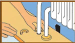
**11.** Подгоните доску, чтобы она встала на место, вклейте на место отпиленный кусок, установите распорку между стеной и доской и закройте зазор вокруг трубы специальным кольцом.
